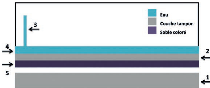
Figure 2. Schéma du dispositif expérimental pour la série A (sable ou silice, plus microbilles de cire d'abeille). 1 Plaque chauffante - 2 Couche de silice - 3 Tube de verre - 4 Couche d'eau superficielle - 5 Sable coloré plus microbilles de cire (LEMARABOTT & COBBOLD, 2010).
