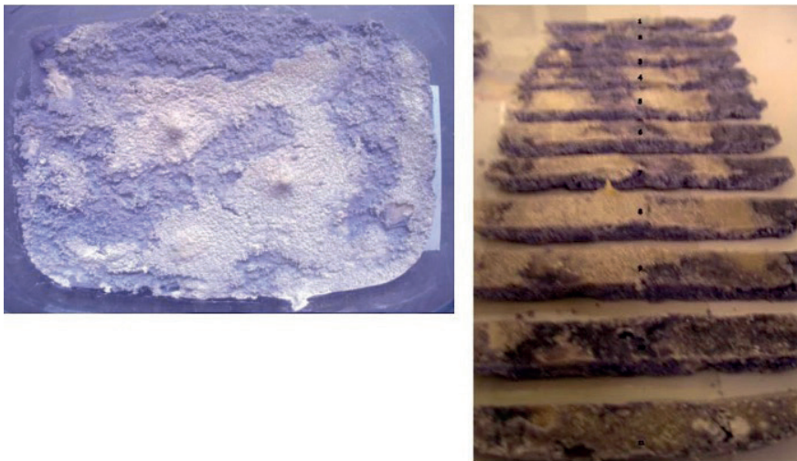
Figure 3. A gauche, vue de la surface de l'expérience N°6 après enlèvement de la couche tampon, qui montre la migration de la cire jusqu'à la barrière de perméabilité et la formation de sills (visible sur la photo de gauche ainsi que sur les coupes à droite) (LEMRA BOTT & COBBOLD, 2010).
