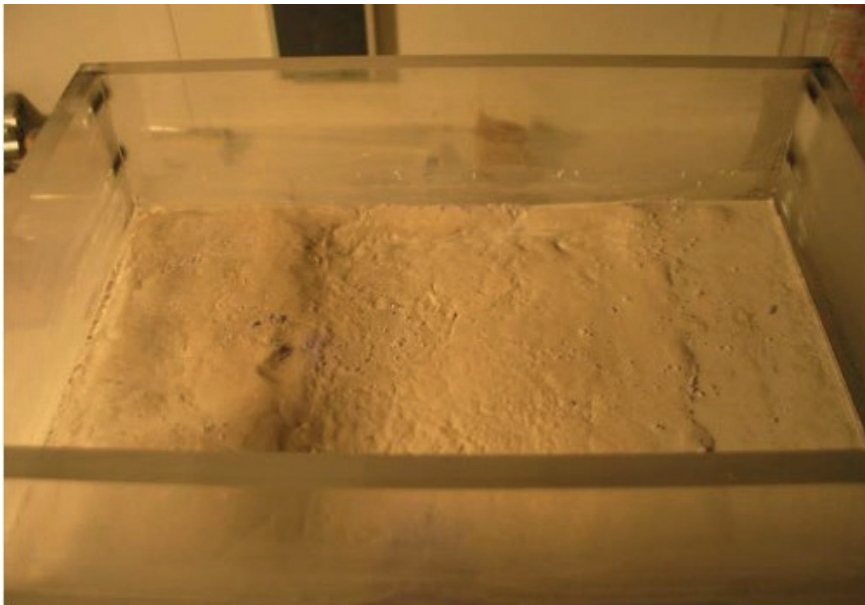
Figure 11. Expérience N° 14 : vue de la surface du modèle qui subit une forte déformation pendant l'expulsion de fluide. (LEMRAVOTT & COBBOLD, 2010).
