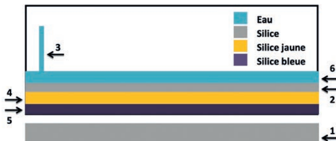
Figure 4A. Schéma du dispositif expérimental pour la série B (silice plus microbilles de cire). 1 Plaque chauffante - 2 Silice - 3 Tube de verre - 4 Silice colorée en jaune plus microbilles de cire - 5 Silice colorée en bleu plus microbilles de cire - 6 Eau (LEMABOTT & COBBOLD, 2010).
